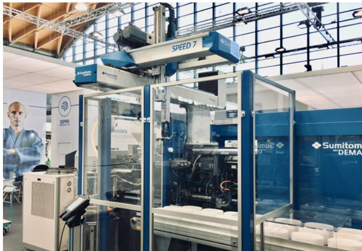
*Una de las dos celdas de automatización del stand de Sepro tendrá una prensa Sumitomo Demag equipada con un robot SDR Speed 7. Fabricado por Sepro especialmente para la venta con las prensas Sumitomo Demag, este robot tiene la capacidad de entrar y salir del espacio del molde en menos de 1 segundo. Descargue un archivo en alta resolución en la siguiente dirección:*
